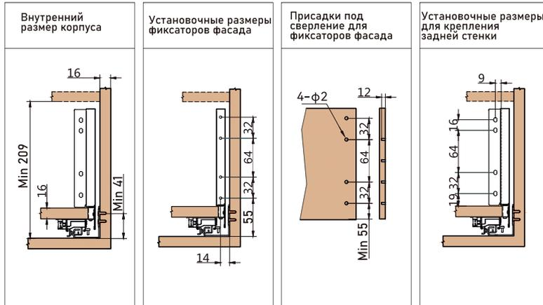
РАЗМЕРЫ ДНА И ЗАДНЕЙ СТЕНКИ ЯЩИКА ПРИ ТОЛЩИНЕ ПЛИТЫ 16 ММ
