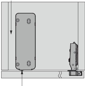
Механизм необходимо устанавливать ближе к противоположной от петли стенке корпуса
