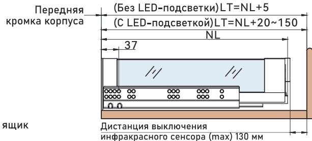
СХЕМА ПРИСАДКИ НАПРАВЛЯЮЩИХ ЯЩИКА (ММ)
