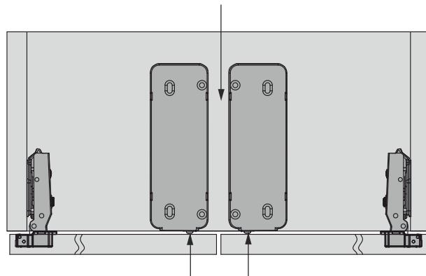
Механизм необходимо устанавливать ближе к противоположной от петли стенке корпуса
