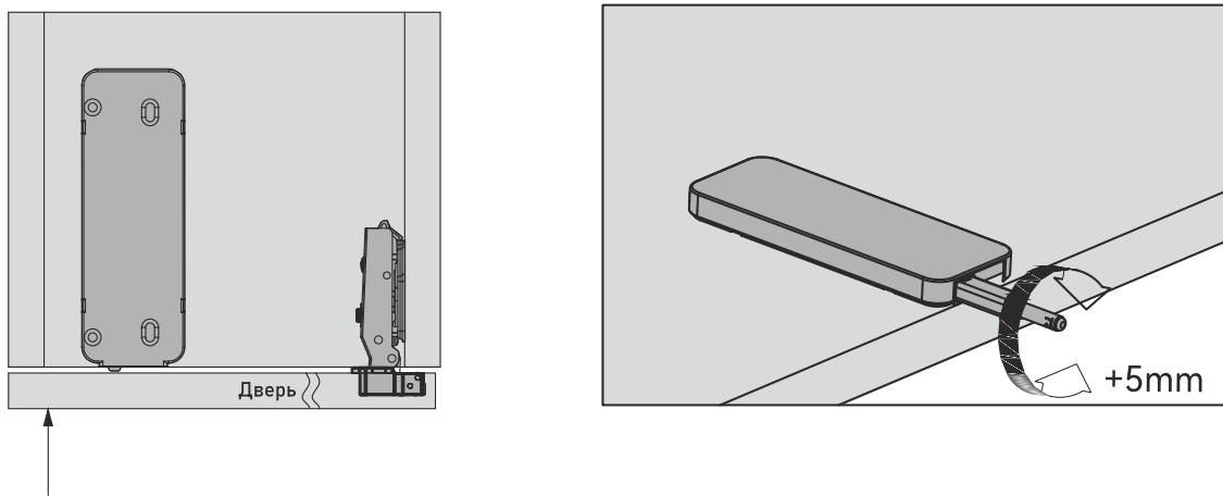
Если после нажатия фасад не открывается, отрегулируйте вращением выступ толкателя для обеспечения хода нажатия.
