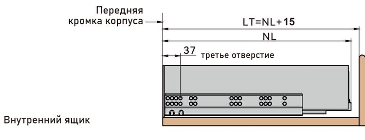
СХЕМА ПРИСАДКИ НАПРАВЛЯЮЩИХ ЯЩИКА (ММ)
