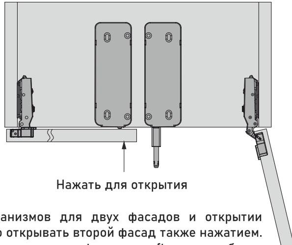
При установке механизмов для двух фасадов и открытии одного из них важно открывать второй фасад также нажатием. Это необходимо для активации функции soft, которая будет действовать при закрывании.
