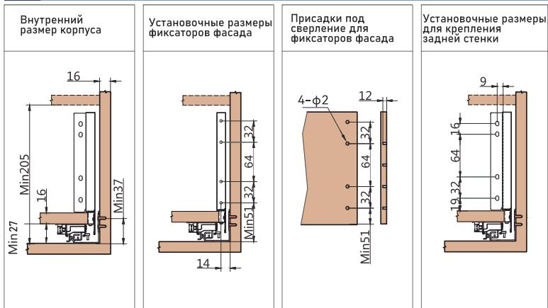
РАЗМЕРЫ ДНА И ЗАДНЕЙ СТЕНКИ ЯЩИКА ПРИ ТОЛСТИНЕ ПЛИТЫ 16 ММ
